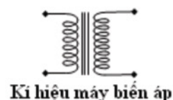
Máy biến áp
